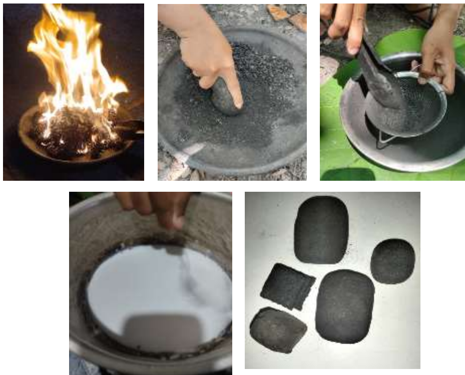
Gambar 2 Proses Pembuatan Briket Bunga Pinus
